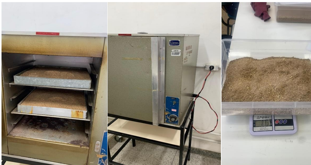
Figura 3. Preparação e pesagem do farelo e tratamento térmico (sanitização), em estufa para eliminação de possíveis contaminantes.
